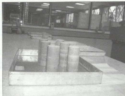
Foto 2. Probetas de suelo estabilizado con sales cuaternarias, que produce mayores índices de CBR.
